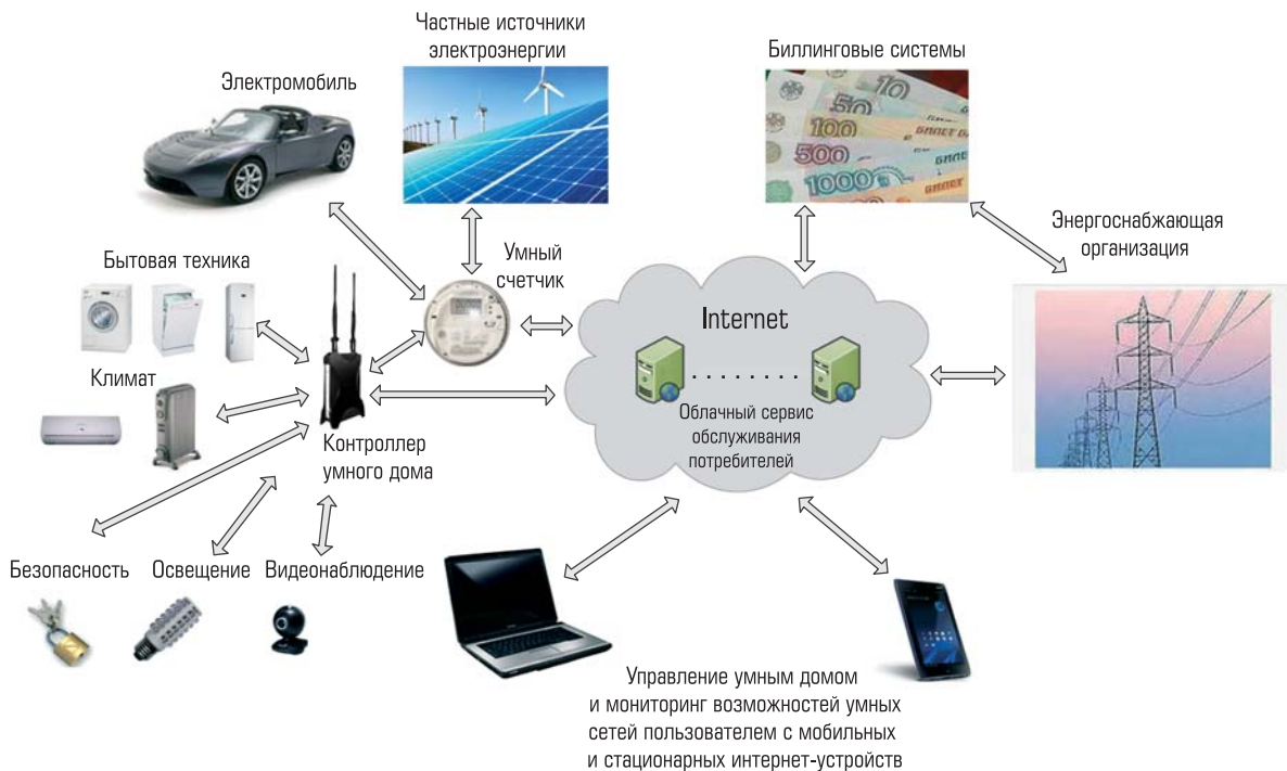
Рис. 1. Структурная схема информационного обмена между потребителем и энергосистемой в рамках концепции Smart Grid
